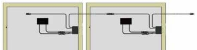
**Schritt 5.** Verbinden Sie den String mit dem Wechselrichter. Nachdem Sie sich vergewissert haben, dass der gesamte String korrekt angeschlossen ist, führen Sie den String in den nachgeschalteten Wechselrichter oder Kombikasten ein.
