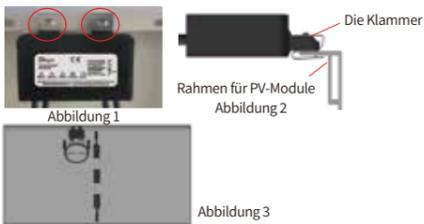
**Schritt 3.** Schließen Sie die Eingangskabel an. Die mit "IN" gekennzeichneten Kabel am Gehäuse des externen Optimierers sind die Eingangskabel und werden mit den Ausgangskabeln des Moduls verbunden.
